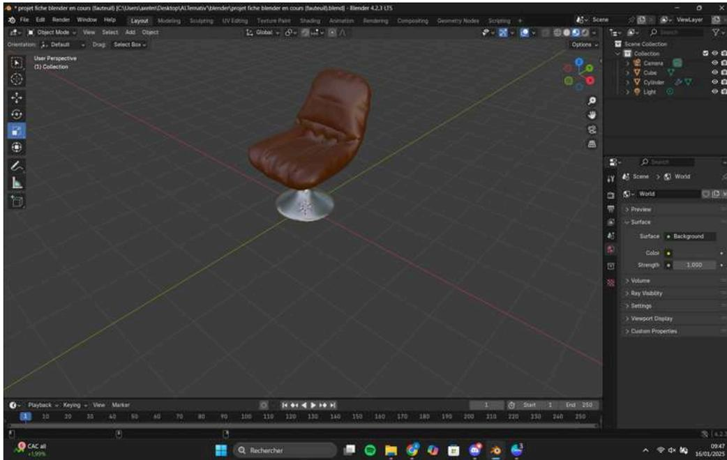
Nous allons maintenant passer au socle, ajouter une nouvelle couleur en sélectionnant notre socle, donner lui une couleur grisâtre, et enfin augmenter le **metallic** à **0.8** et le **roughness** à **0.3**.
