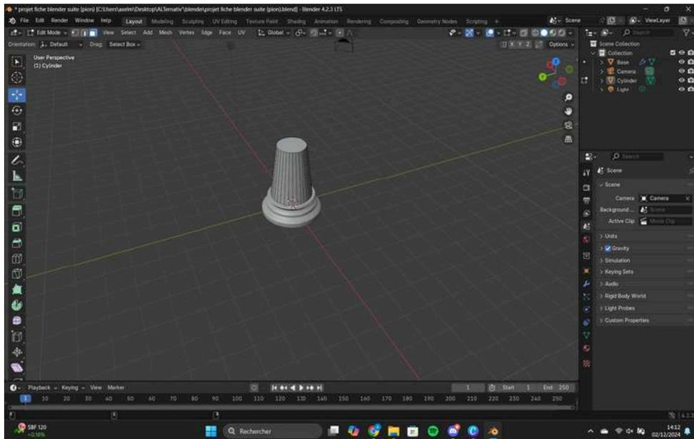
Repassez en **object mode** pour déplacer votre cylindre avec l'outil “**move**” et collez le sur votre base. Passez en **edit mode** et en **sélection de faces** en sélectionnant la face haute de votre cylindre et avec l'outil “**move**” augmenter la taille de votre cylindre sur l'axe **Z**.
