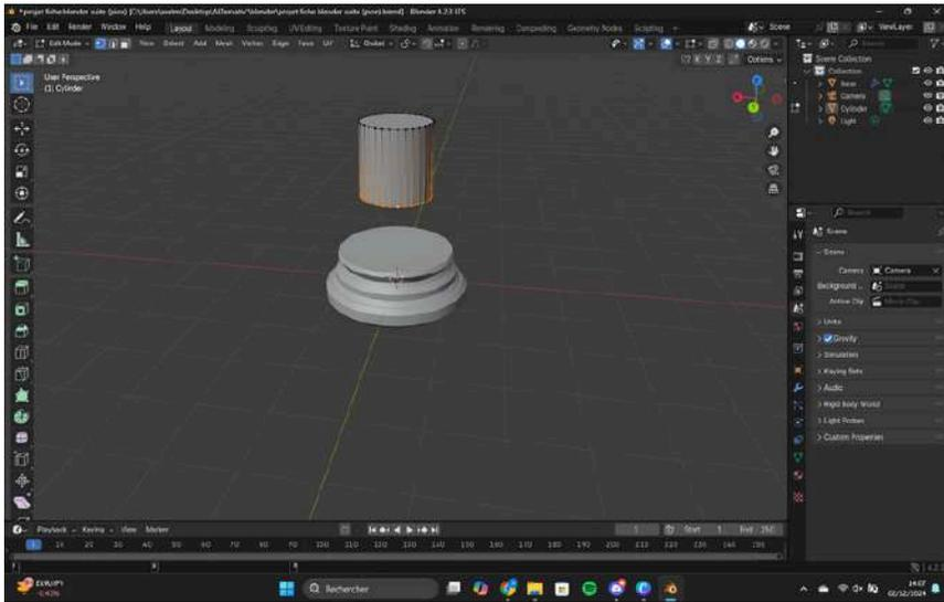
Ajoutez un cylindre avec **add**, **mesh** et **cylinder**. Ensuite vous allez pouvoir le réduire avec l'outil "**scale**" et sélectionnez chaque point du bas du cylindre en **edit mode** et en **sélection de point (ALT + clic Gauche)**.
