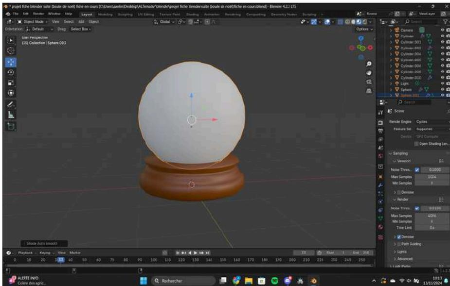
Passez en **cycles** et **GPU compute** dans l'onglet **render** à droite et passez également en **rendered** dans le **viewport shading**. Ajoutez une **UV Sphere**. Passez lui un coup de **shade auto smooth**.
