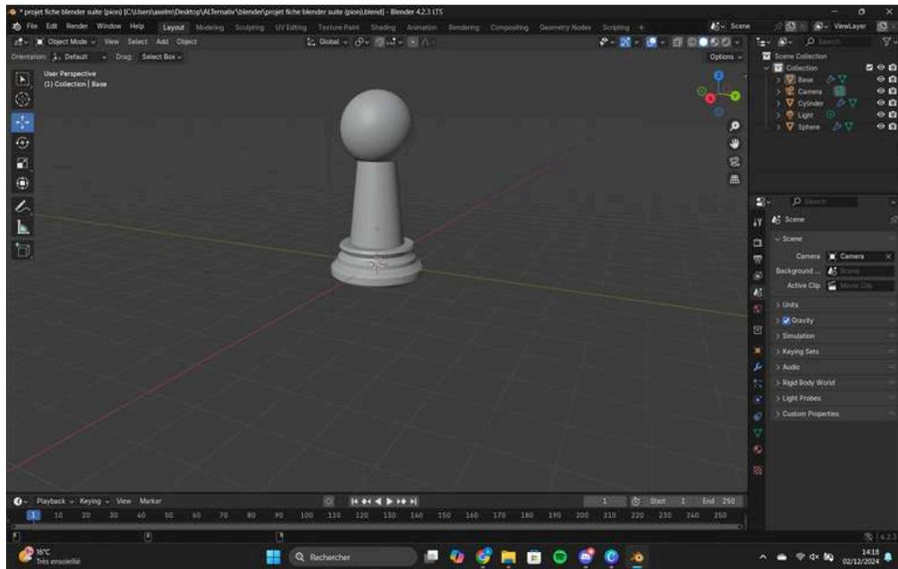
Il ne reste plus qu'à ajouter une **UV Sphere** avec "add" puis "mesh" et la déplacer avec l'outil "move" et de faire un coup de **shade auto smooth** sur le cylindre et notre UV Sphere.
