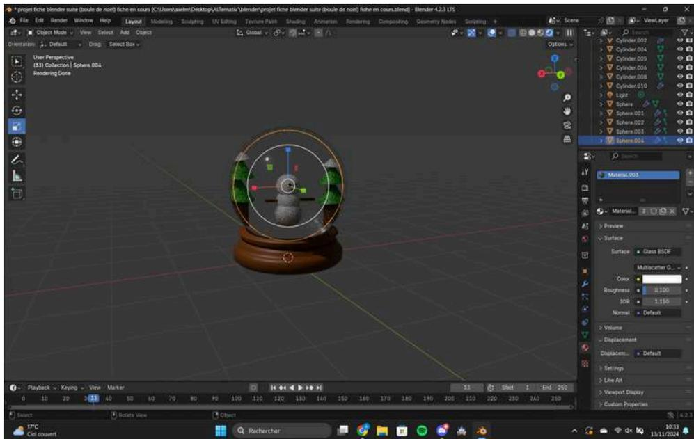
**Dupliquez** notre UV Sphere et placez la à la même place que notre UV Sphere de base, réduisez la taille de notre deuxième UV Sphere avec l'outil “**scale**”.
